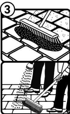
A pesar de que NOCOSTORM™ es un producto que no requiere compactación en la mayoría de los casos, es fundamental que las juntas se rellenen completamente. Para juntas muy estrechas o con adoquines gruesos, la compactación mecánica con una placa compactadora o un rodillo compactador ayudará a garantizar el relleno de las juntas.
