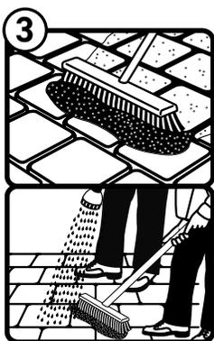
Apesar de o NOCOSTORM™ ser um produto que não requer compactação na maioria das circunstâncias, é fundamental que as juntas sejam completamente preenchidas. Para juntas muito estreitas e/ou com blocos espessos, a compactação mecânica utilizando um compactador de placa ou um cilindro compactador ajudará a garantir o preenchimento total das juntas.
