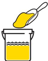
多余产品可收集起来重新装回原容器，以便下次使用。产品可在几周之内继续使用。剩余产品应用水完全密封起来（水深约 50 毫米 (2")），以防在容器内固化。如果产品已经开始固化，请勿再装回容器。请勿将产品重新密封在包装袋中，因为此时密封已经失效了。重新将容器盖紧。
