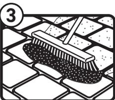
尽管大多数情况下 NOCOSTORM™ 都无需压实，但请务必确保接缝位置彻底填满。对于较窄的接缝区域和/或较厚的铺路石，可使用平板夯或摊铺机进行机械压实，确保接缝区域已填满。
