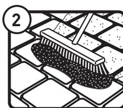
2 使用扫帚将接缝填满。短距离铺开接缝砂。
